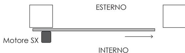
Se il motoriduttore è posizionato a sinistra intervenire nel menù **CC** parametro **C6** e inserire la funzione 1 (inversione automatica del motore e dei finecorsa)
