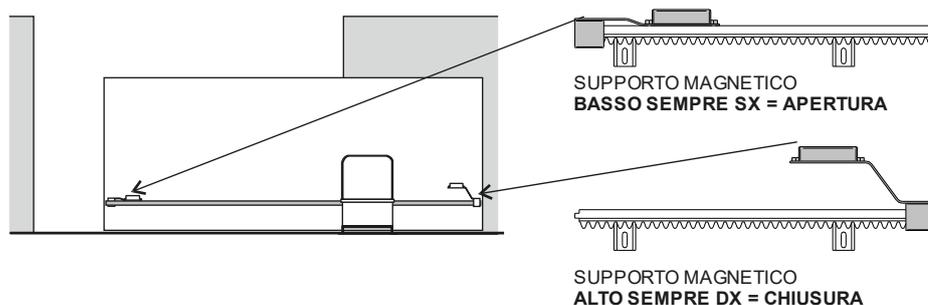
Se il motoriduttore è posizionato a sinistra intervenire nel menù **CC** parametro **C6** e inserire la funzione 1 (inversione automatica del motore e dei finecorsa)
