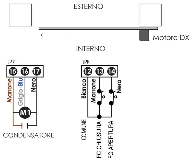
Di Default il motore viene precabato per il funzionamento come indicato il figura: motore posizionato a destra.
