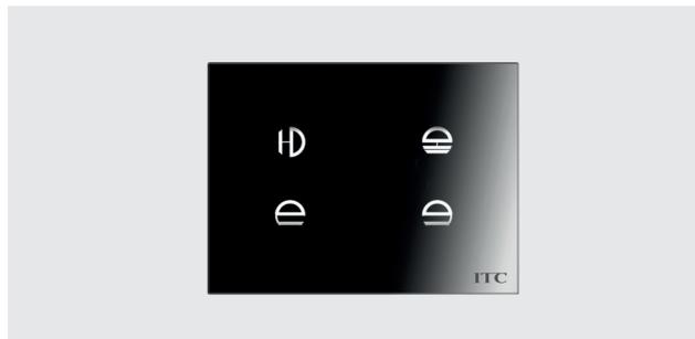
Pannello touch in vetro temperato a variazione capacitiva per ON/OFF e regolazione intensità luminosa di 4 punti luce. Collegamento all'unità UGL-IP, UGC-IP, UGT-IP o ad ulteriori unità e pannelli mediante connettori RJ12 per trasmissione dati e per alimentazione a 12Vdc. Alloggiamento in scatola da incasso 3 posti. Dimensioni 127x95x9mm (+44mm interni). Peso 0,2 Kg. Colore nero, bianco.
