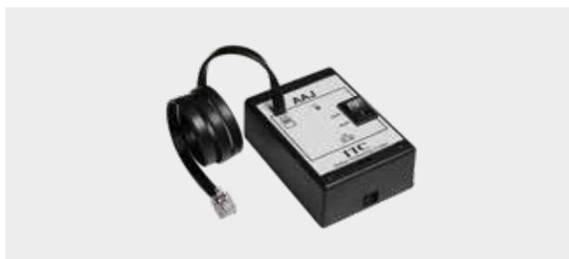
Rileva la presenza del cliente all'interno della camera mediante chiusura di un contatto pulito esterno ed attiva i relativi servizi. Viene installato nel quadro elettrico di camera e collegato all'unità di controllo UGC mediante cavo a 6 conduttori, terminato con PLUG telefonico 6/6. Dimensioni: 64x89x40mm. Peso 0,1Kg.
