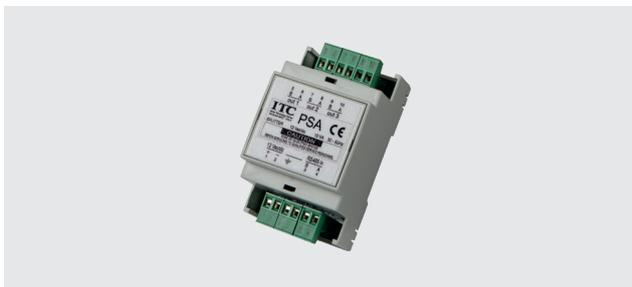
Amplifica il segnale in ingresso e lo ripartisce su tre uscite distinte. È realizzato in scatola a 3 moduli per barra DIN. Alimentazione 12Vac/dc, 15VA. Dimensioni (l x h x p): 54x96x58 mm. Peso. 0,1 kg.
