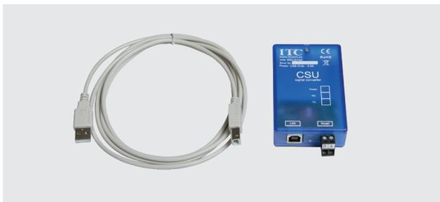
Convertitore di segnale da USB a RS485 half duplex. Alimentazione 5Vdc da porta USB. Morsetto estraibile a 2 vie per connessione bus RS485. 3 led di segnalazione: rosso - alimentazione; blu - TX; verde - RX. Cavo USB di collegamento in dotazione (Connettori maschio Type B - Type A). Dimensioni (l x h x p): 105x25x57 mm. Peso: 0,05 Kg.
