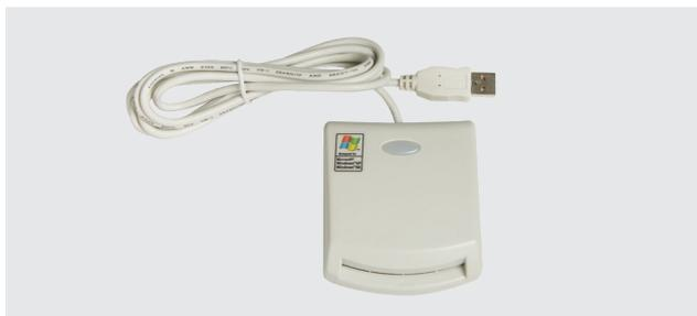
Lettoře/scrittore di chip card in versione da tavolo, completo di cavo di connessione al PC tramite porta USB. Dimensioni (l x h x p): 72x28x84 mm. Peso. 0,1 kg.
