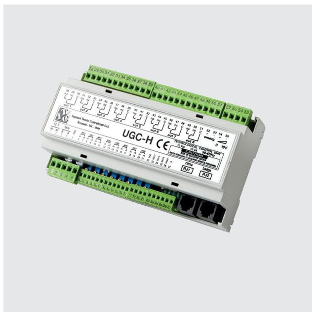
L'unità di controllo UGC-H è realizzata in scatola a 9 moduli per barra DIN. Dispone di 8 ingressi analogici e 4 ingressi digitali per il collegamento dei seguenti dispositivi:
