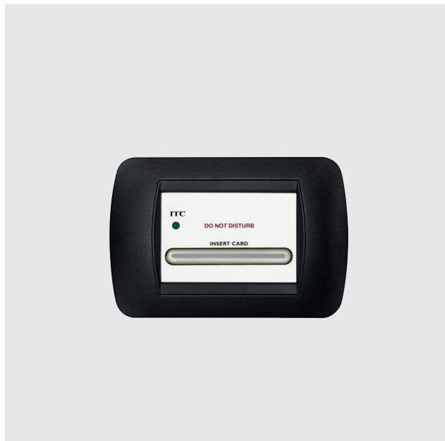
Consente l'accesso alla camera in maniera differenziata per cliente, direttore, personale di servizio, manutentore, ecc. È dotato di bocchetta di inserimento illuminata per chip card formato ISO 7816 e di led per indicazione validità tessera e stato camera (libera/occupata).
