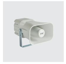
Diffusore passivo sporgente da parete 20W indicato per un'ottima qualità di riproduzione degli annunci vocali e della musica di sottofondo. Corpo in policarbonato autoestinguente in classe V2. Completo di trasformatore di linea con potenze selezionabili per una migliore regolazione del livello sonoro. Disponibili nei colori: bianco, nero e grigio.
