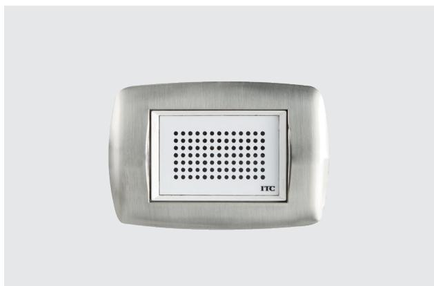
Montaggio in scatola da incasso 503 che occupa interamente. Indicato per l'installazione in camere dove vi sono problemi di ingombri ridotti. Le dimensioni dell'altoparlante consentono di avere una potenza di 3 W. Corredato di modulo amplificatore CA10MP da alloggiare separatamente. Disponibile in molteplici serie civili. Peso: 0,16 Kg.
