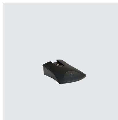
Base da tavolo per microfoni gooseneck estraibili. Corpo in metallo verniciato e fondo dotato di gommini antiscivolo. Dotato di pulsante e relativo led di segnalazione di attivazione. Connettore XLR femmina sulla parte superiore e connettore XLR maschio sul retro. Colore grigio scuro.
